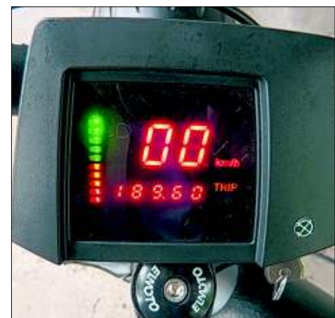
Die grünen, orangenen und roten Lichter zeigen den Ladezustand des Akkus an Foto: privat
